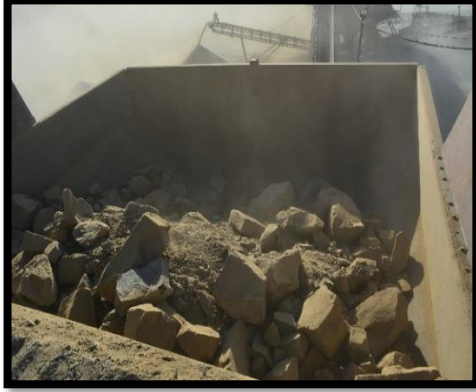
تفريغ الخام بالكسارة شكل الخام قبل طحنة في الكسارة
